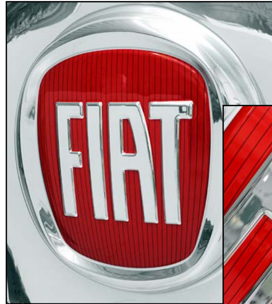
Siebdruck zweifärbig auf DM Silver, thermisch verformt.
